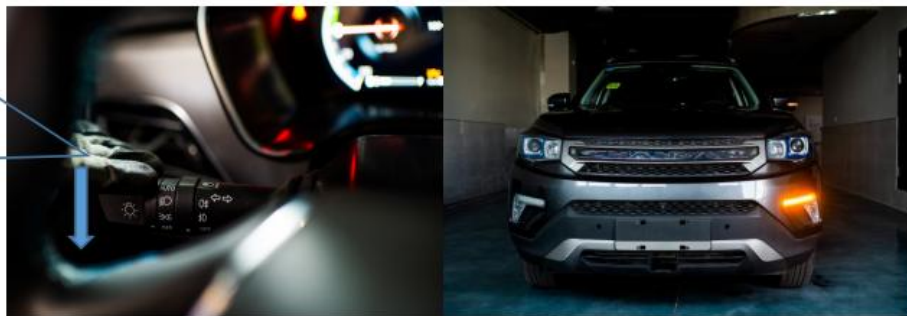
图 3-37 (b) 前方左转向灯灯光操作与点亮位置
