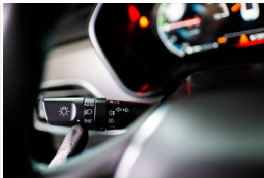
图 3-41 (b) 后方小灯和牌照灯灯光操作与点亮位置
