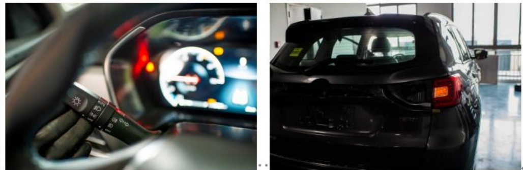
图 3-45 (b) 后方转向灯灯光操作与点亮位置
