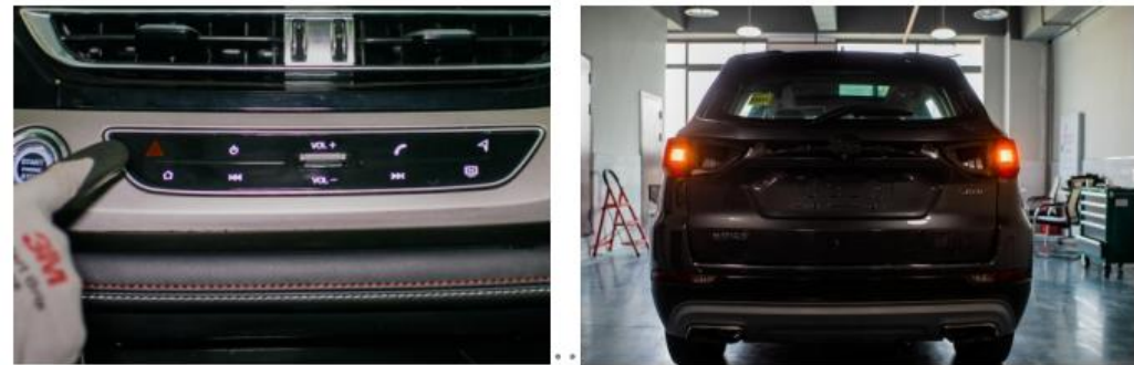
图 3-46 (b) 后方危险警示灯灯光操作与点亮位置
