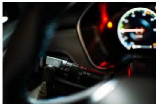
图 3-35 (b) ·前方远光灯灯光操作与点亮位置
