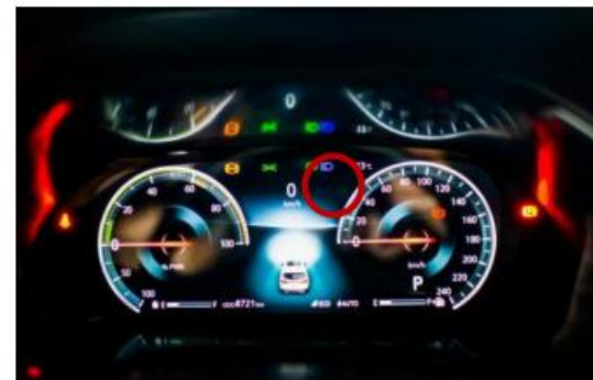
图 3-35 (c) 仪表盘远光灯灯光点亮指示
