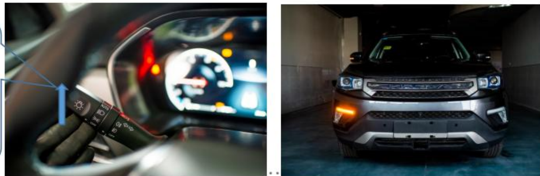
图 3-38 (b) 前方右转向灯灯光操作与点亮位置
